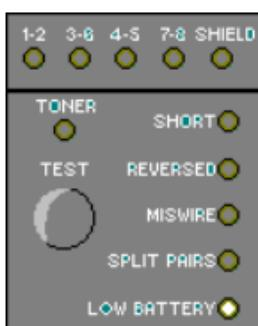
El LED de batería se encenderá cuando **MICROMAPPER** detecte que la batería está baja. La precisión de las pruebas puede verse afectada si se utiliza **MICROMAPPER** con un nivel de carga bajo. Si no se va a utilizar **MICROMAPPER** durante un período superior a un mes, es conveniente que extraiga la batería.
