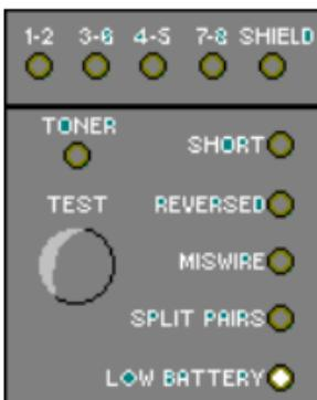
Die Batterieanzeige leuchtet auf, wenn der **MICROMAPPER** feststellt, dass die Batterieladung zu niedrig ist. Eine niedrige Batterieladung kann sich auf die Prüfgenauigkeit des **MICROMAPPER** auswirken. Wenn der **MICROMAPPER** länger als einen Monat nicht in Gebrauch ist, sollte die Batterie ausgetauscht werden.
