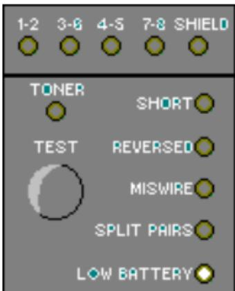
O Indicador Luminoso de Bateria se acende quando o **MICROMAPPER** detectar que a carga da bateria está baixa. O uso do **MICROMAPPER** com bateria fraca pode afetar a precisão do teste. Se o **MICROMAPPER** precisar ficar guardado por mais de um mês, a bateria deve ser retirada.
