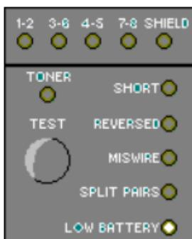
Il LED batteria si accende quando **MICROMAPPER** rileva la condizione di batteria scarica. L'uso di **MICROMAPPER** con la batteria scarica può pregiudicare la precisione dei test. Se **MICROMAPPER** non viene utilizzato per oltre un mese occorre rimuovere la batteria.
